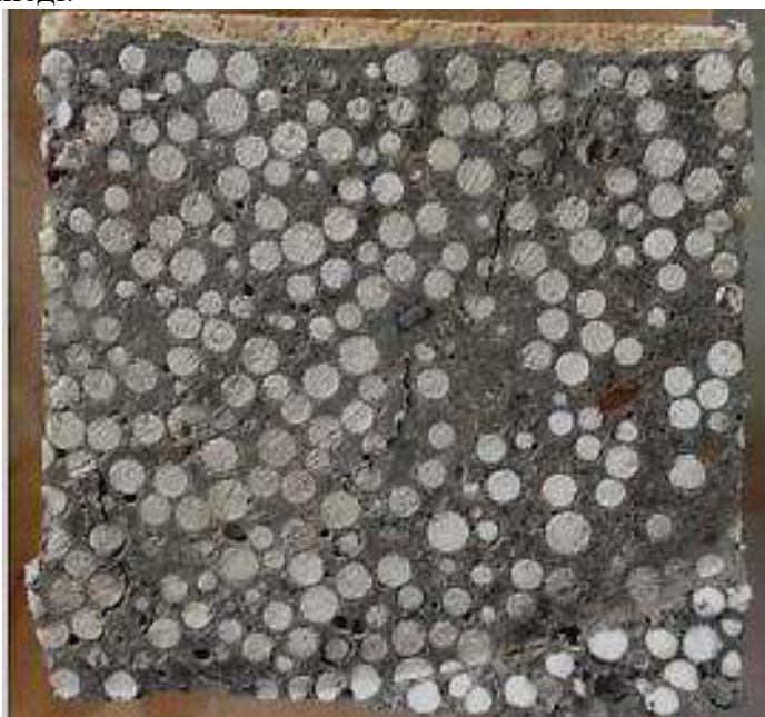
Сурет – 1. Қысу беріктігін анықтауға сыналған полистиролбетон үлгісі
